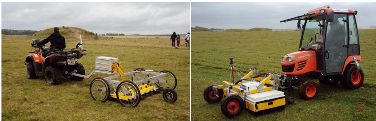
Abb. 120: Motorisierte Messsysteme des LBI für archäologische Prospektion und virtuelle Archäologie, welche mit Arrays von Caesium- bzw. Fluxgatesensoren und Radarantennen arbeiten (Fotos: Michael Doneus).
