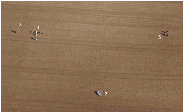
Abb. 113: Luftbild des Teams von ArcheoProspections® im Bereich der Kreisgrabenanlage von Kleinrötz – Detail. (1) Multisensor Caesiumgradiometer, (2) Datenlogger, (3) Latten mit dazwischen verlaufenden Richtschnüren (© Michael Doneus).
